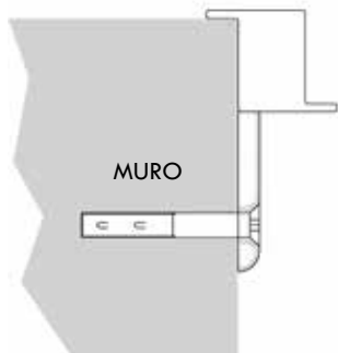
FISSAGGIO CON TELAIO IN Z
